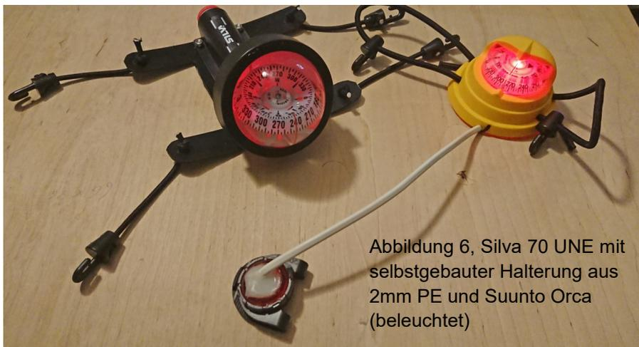
Abbildung 6, Silva 70 UNE mit selbstgebaute Halterung aus 2mm PE und Suunto Orca (beleuchtet)
